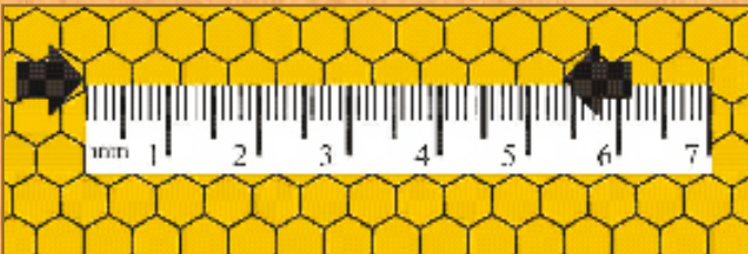
Grafik 1: Die Zellgröße wird ermittelt, indem jeweils 10 Zellen in einer gleichmäßigen Zellreihe zusammen vermessen werden (Bildquelle: Tobias Stever, privatwissenschaftliches Archiv für Bienenkunde)
